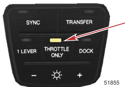
Bouton « THROTTLE ONLY » (Mode spécial d'accélération)
